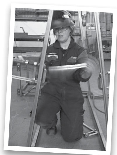
Erilaiset lavasterakennelmat ovat Miisa Hatakan työtä, tälläerää kuljetusteline peräkärriyn.
